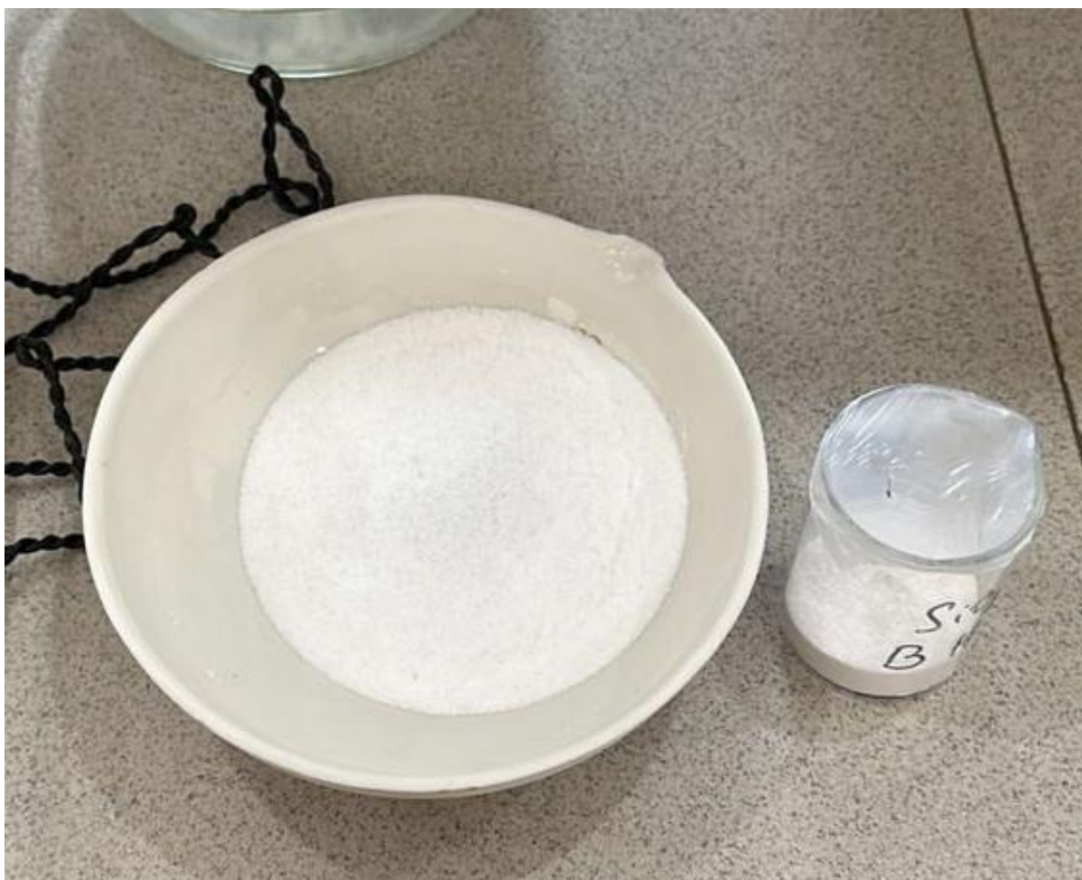
1-Сурет. Күріш қауызынан алынған кремний диоксиді
