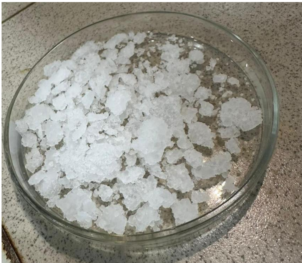
5-Сурет. Сүзгіден өткен кремнезем гелі
