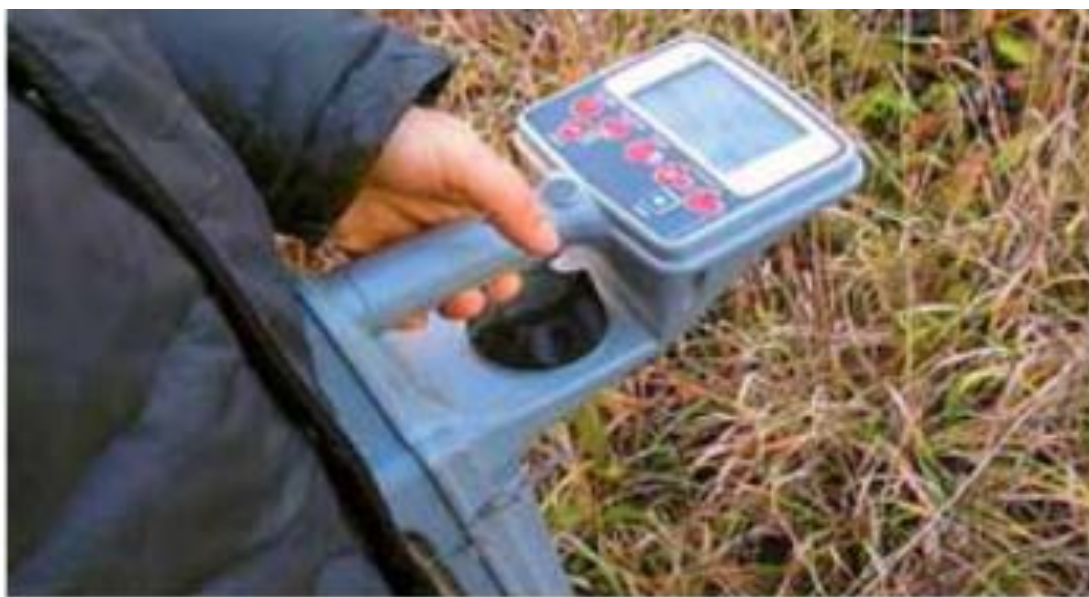
Сурет 6 - Radiodetection трасса детекторының көмегімен жер асты құбырының коррозиялық және механикалық зақымдану орнын анықтау
