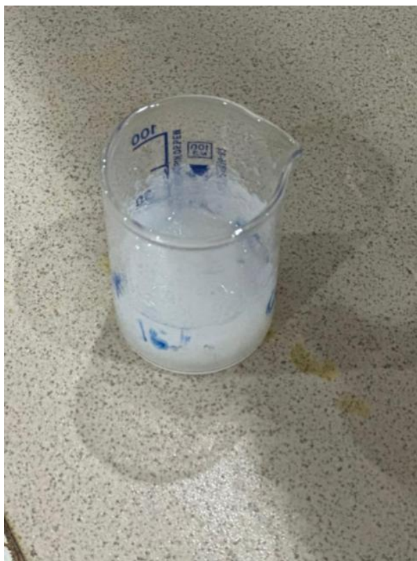
3-Сурет. Натрий силикаты ерітіндісін тұз қышқылымен бейтараптандыру нәтижесінде алынған кремнезем гелі
