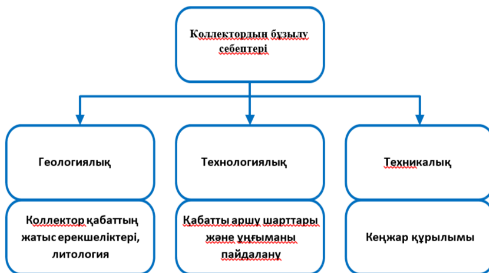
3-сурет. Коллекторлық қабаттың бұзылуының негізгі себептері
