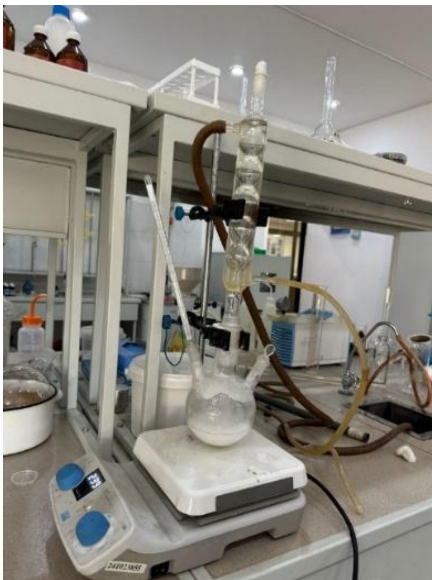
2-Сурет. Магнитті қыздырғыш-плитада натрий силикатын алу процессі
