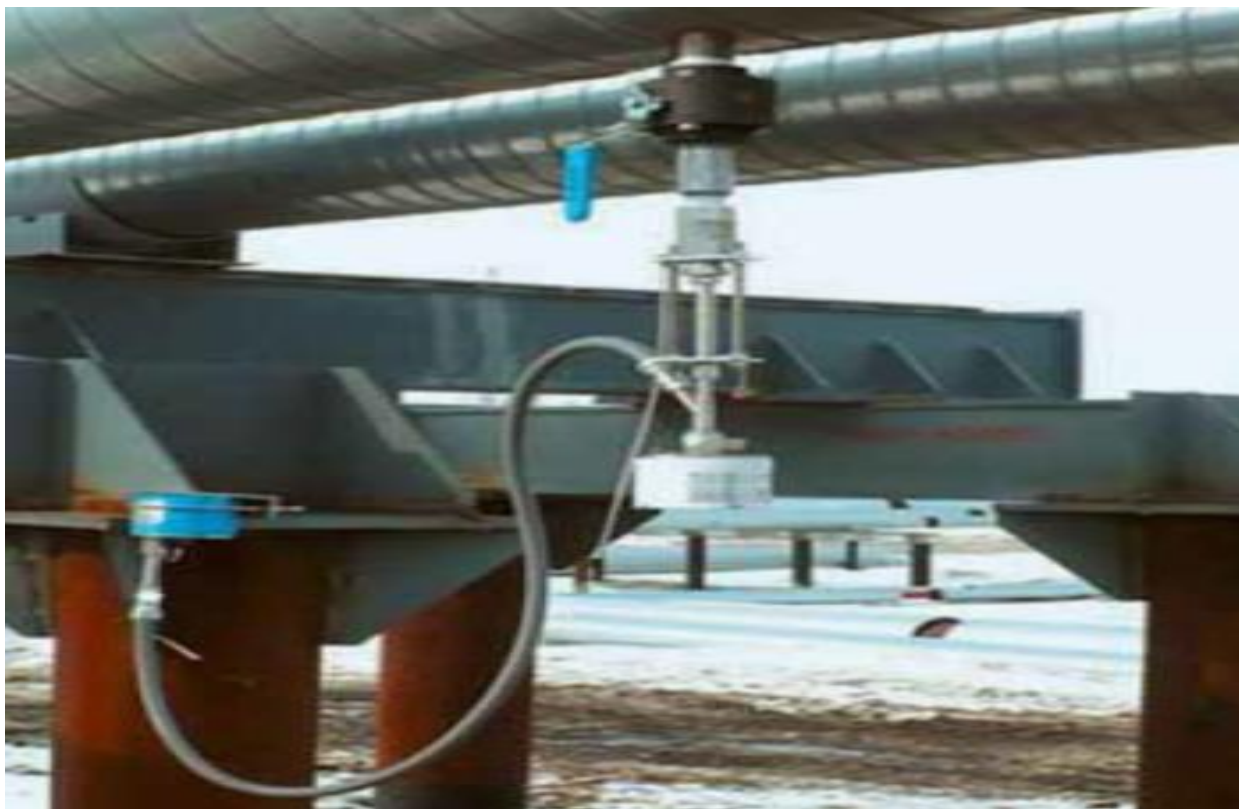
Сурет 8 - Microcor және Ultracorr жүйелерін пайдалану
