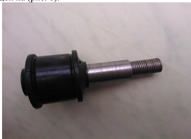
Рисунок 6. Сайлентблок амортизатора новой конструкции с пружинным вкладышем перед сборкой
