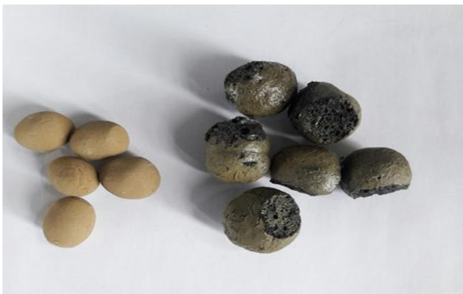
Сурет 1 - Конгломерат қоспалы әртүрлі құрамды жеңіл жылуоқшаулағыш толтырғышты күйдірілген түйіршіктердің кеукті макроструктурасы.
