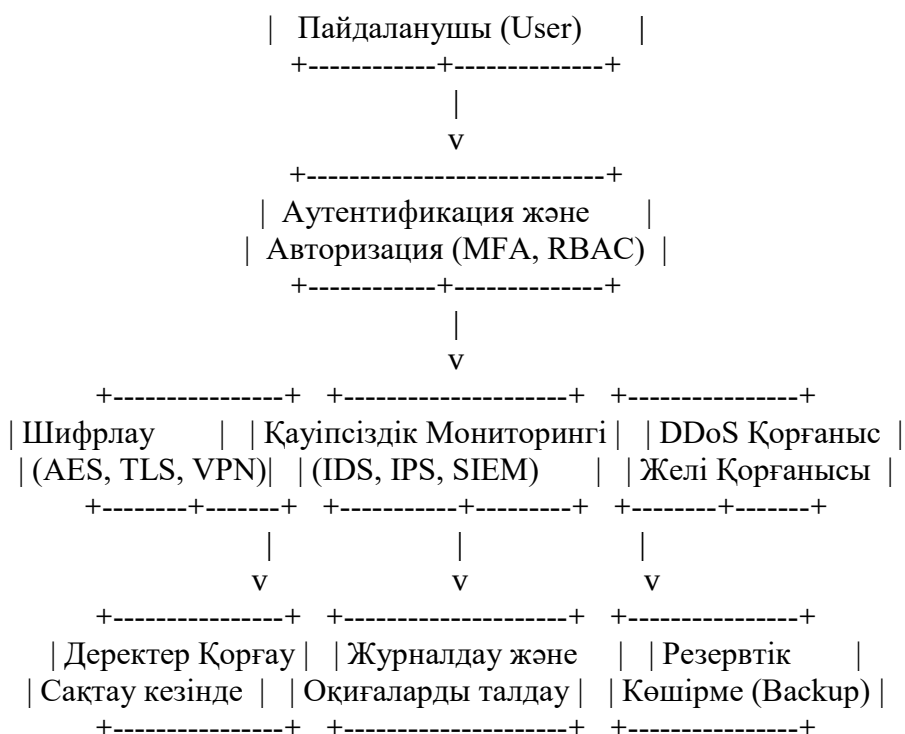
1 сурет. Бұлтты есептеулердің қауіпсіздік схемасын көрсететін диаграмма
