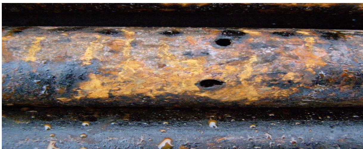
Сурет 1. Минеральды тұздар әсерінен коррозияға ұшыраған жабдық
