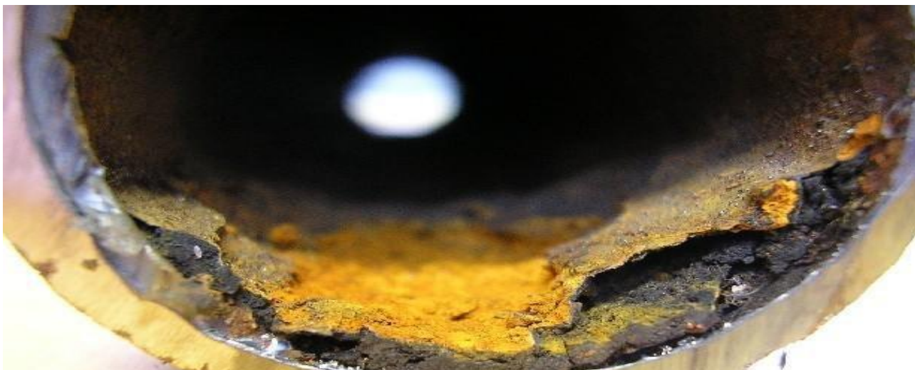
Сурет 2. Күкіртті қосылыстардың әсерінен коррозияға ұшыраған жабдық
