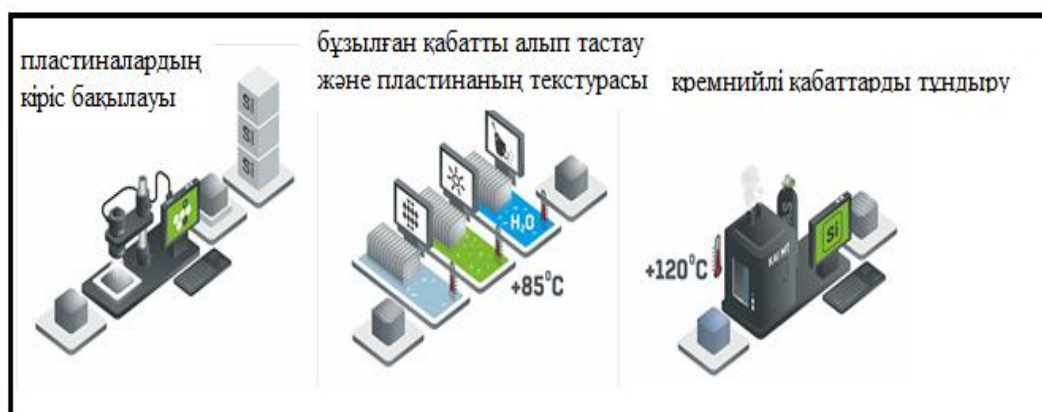
2- сурет. Өндіру технологиясының 1,2,3 кезендері.
