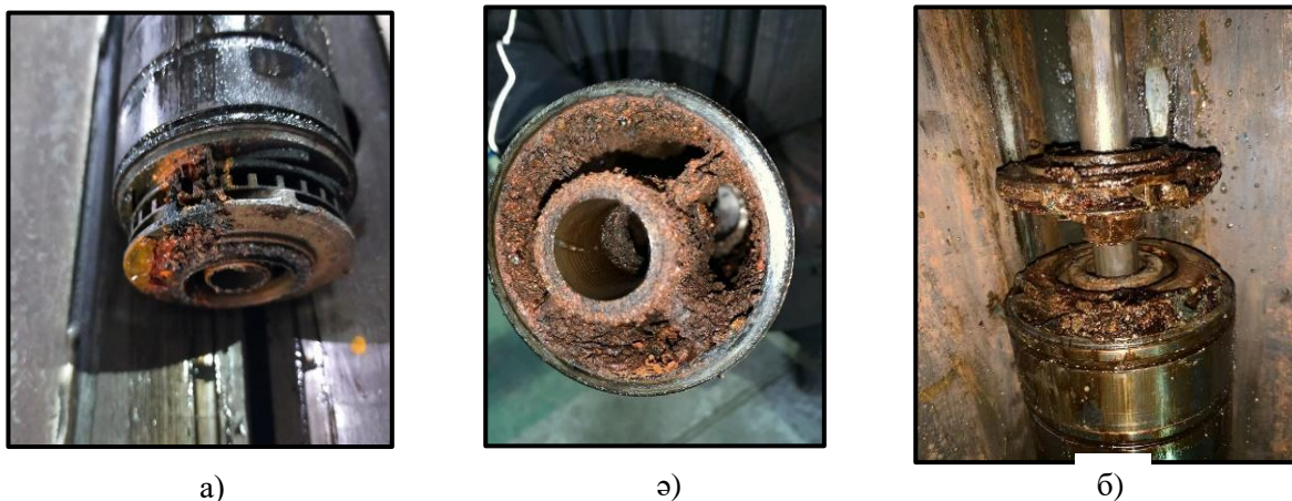
2-сурет. Сораптың механикалық қоспалар әсерінен ақаулық өзгеруі:
