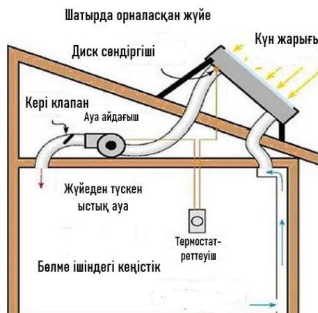
б сурет - Ауа коллекторының жұмыс принципі
