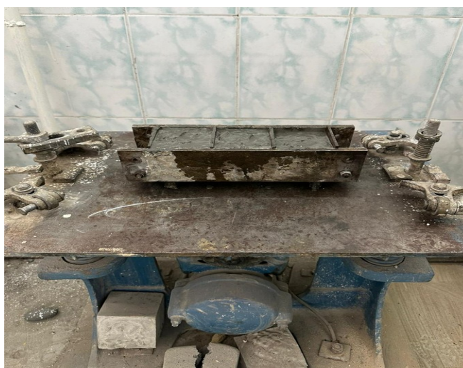
2.6 сурет – Үлгілерді дірілдетіп нығыздау сәті
