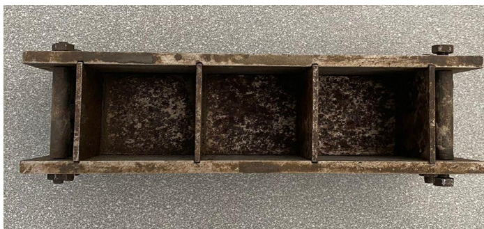
2.5 сурет – Зеттеу жұмыстарын жасауға арналған темір қалып
